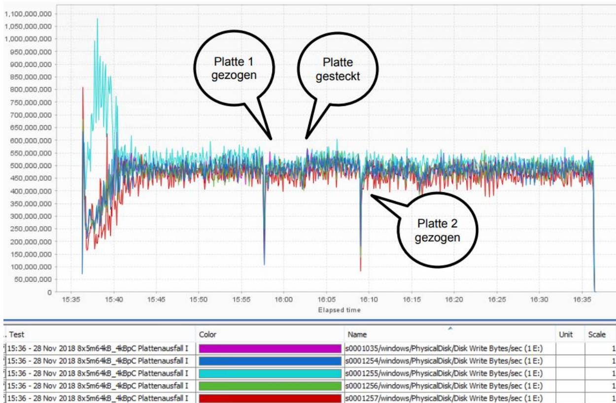
Abbildung 4: Beeinträchtigung des Schreib-Durchsatzes bei Ausfall einer Platte eines Flash-Blockspeichers
